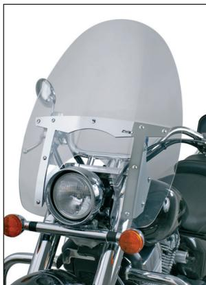
En las revisiones del vehículo es conveniente efectuar también el mantenimiento de apriete de toda la tornillería del carenabris, especialmente los tornillos que fijan éste al vehículo.
